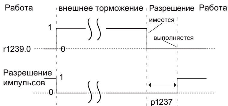
Изображение 6-3 Разрешение импульсов - характеристика сигнала короткого замыкания якоря без квитирования контактора
