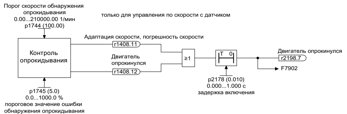
Изображение 8-2 Защита от опрокидывания
