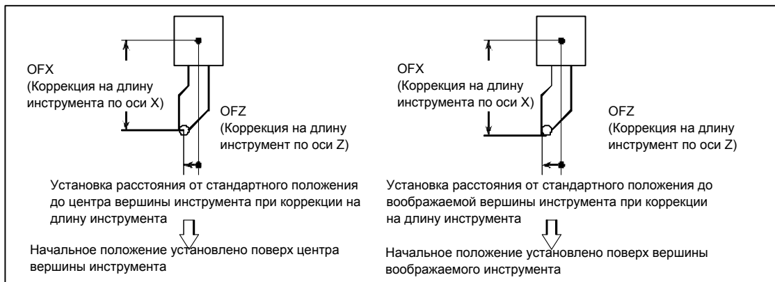
Рис. 6.5.1 (b) Величина коррекции на длину инструмента, когда центр револьверной головки располагается поверх начальной точки
