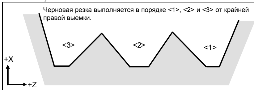
Рис. 5.8.1 (l) Порядок чернового резания в случае монотонного убывания (тип II)
