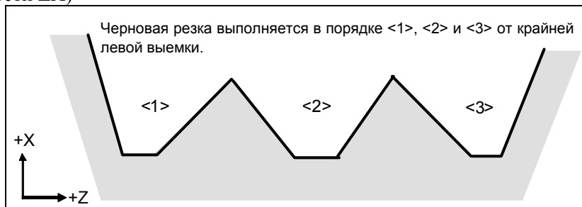
Рис. 5.8.1 (m) Порядок чернового резания в случае монотонного увеличения (тип II)
