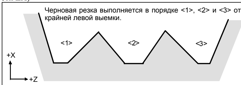
Рис. 7.1.1 (n) Порядок чернового резания в случае монотонного возрастания (тип II)
