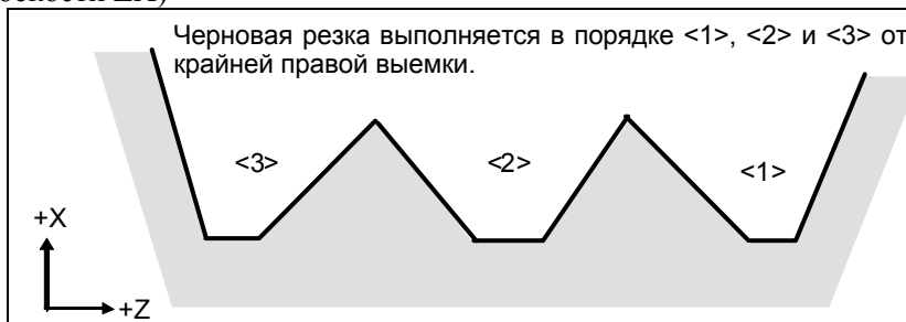
Рис. 7.1.1 (m) Порядок чернового резания в случае монотонного убывания (тип II)
