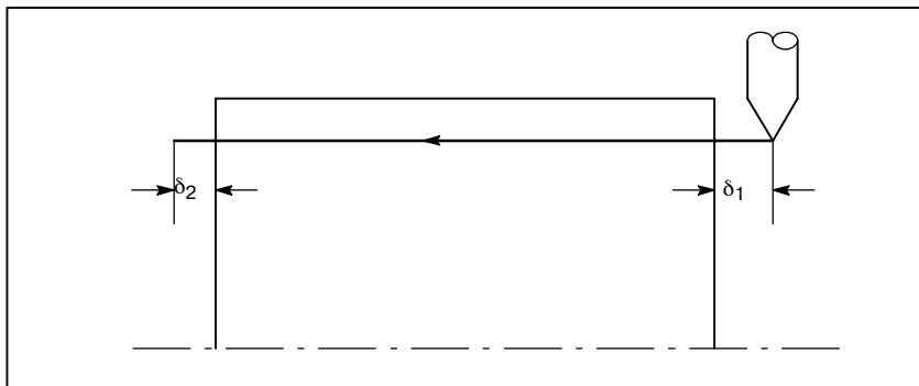
Рис. D.2 Участок с неверной резьбой
