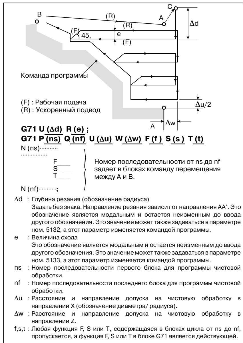
Рис. 13.2.1 (а) Траектория резания во время удаления припусков при точении (Тип I)
