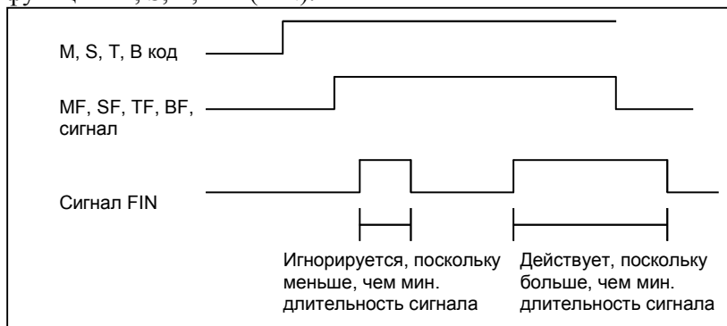
Рис. 4.19 (b) Действительная длительность сигнала FIN (завершение функций M, S, T, и B)
