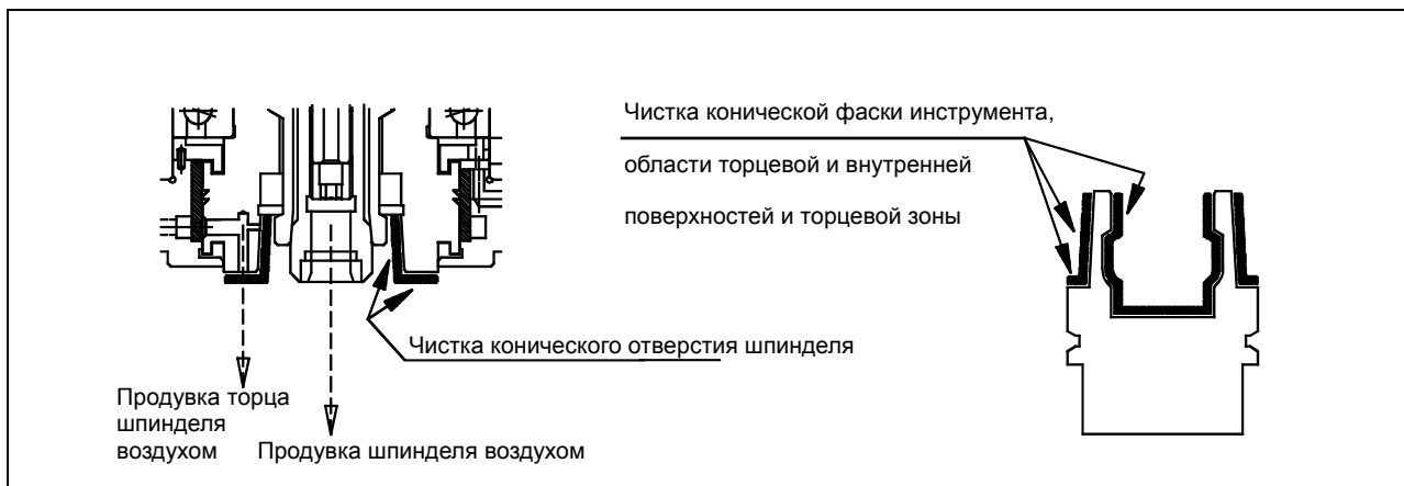
Рис. 4-13 Чистка конической фаски инструмента и зоны вокруг конического отверстия шпинделя
